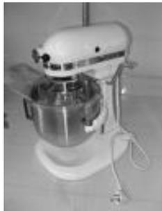
Las espumas se formaron usando una batidora planetaria modelo K5SS, KitchenAid Inc., Michigan, U.S.A. (Figura 2.1), con el mezclador de globo de alambre (batidor K45WW).
