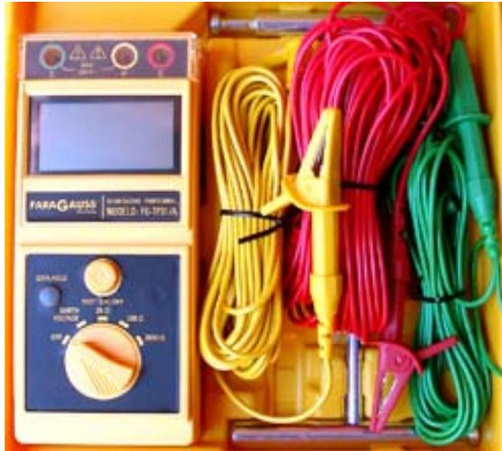
Fig. 3.10. Telurómetro Marca Faragauss System FG-TP01/A
