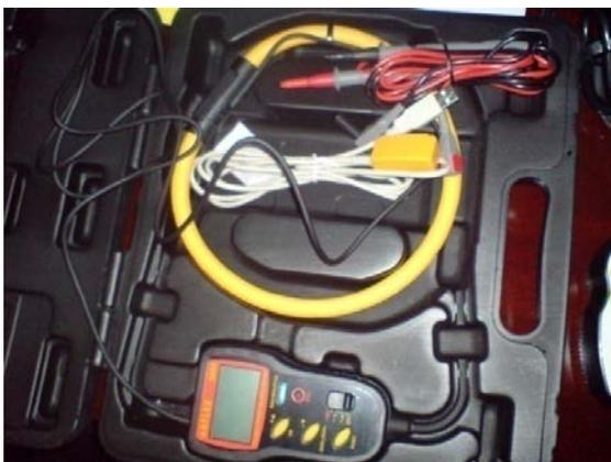
Fig. 3.12. Multímetro de gancho aflex 300.
