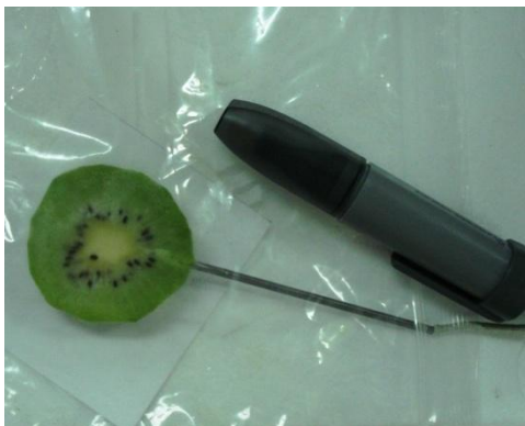
Figura 5. Termopar introducido en una rodaja de kiwi sometida a descongelación en una bolsa de polietileno.
