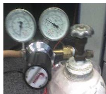
Fig. 4.28 Cilindro gas portador con su respectiva válvula
