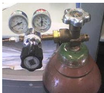
Fig. 4.27 Cilindro gas Helio con su respectiva válvula
