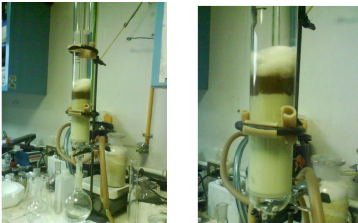
Figura 8. Fraccionamiento del extracto activo por medio de columna con gel de sílice
