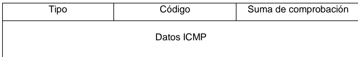
II.9.1.2 Estructura de los mensajes de ICMP
