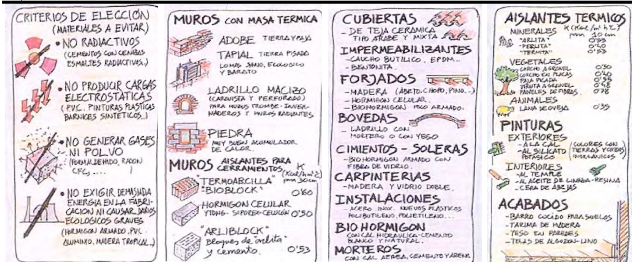
FIG. XXIX. Extraída con fines didácticos. Bocetos que demuestran los materiales que se deben evitar, y algunas consideraciones para el buena elección de los mismos, en las construcciones.
