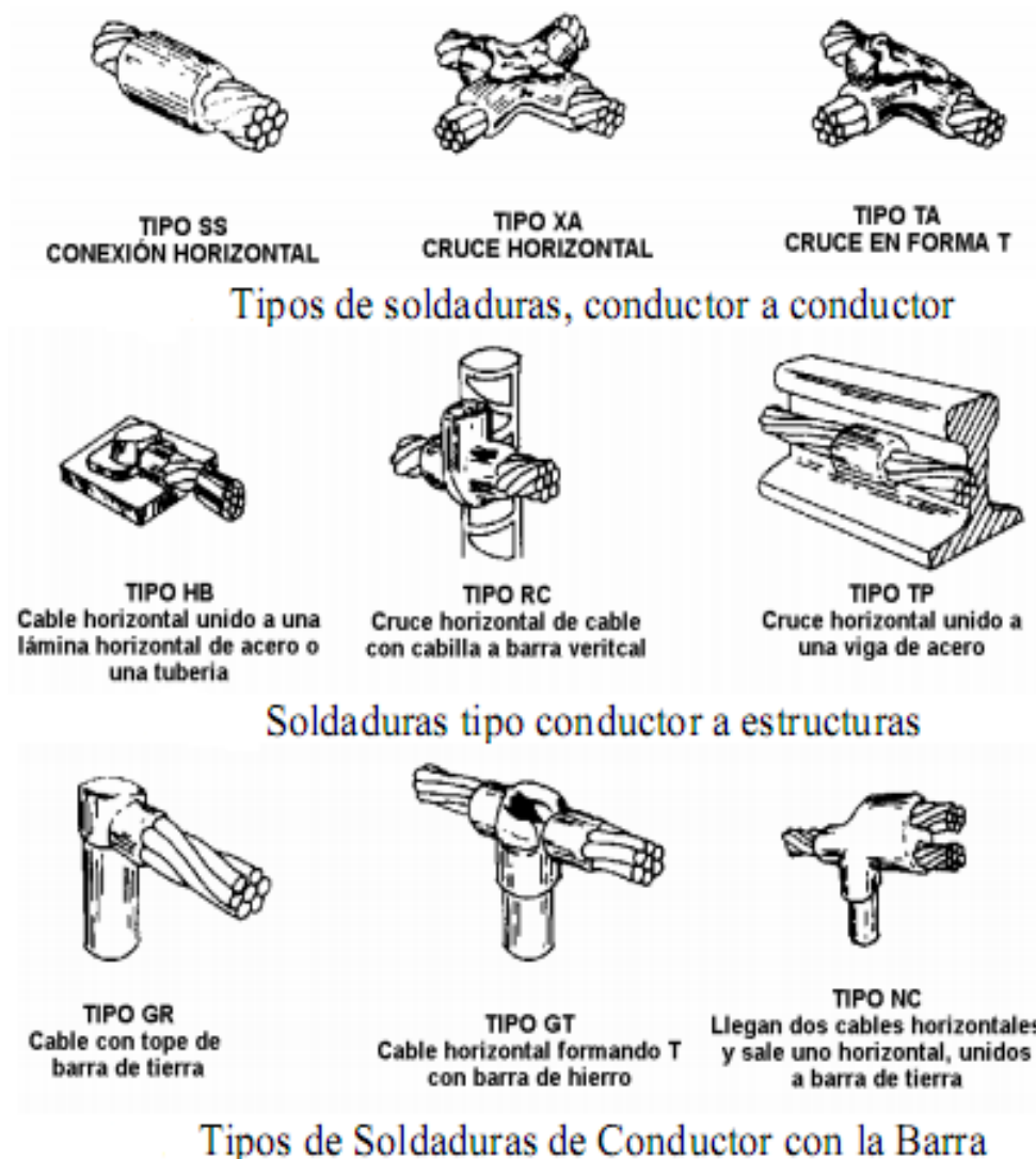
Figura 3.12 Tipos de soldaduras
