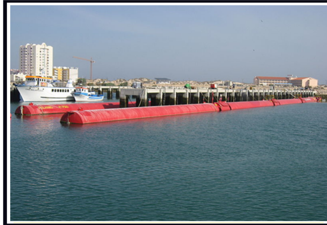
Figura 2.9 Convertidor de energía de olas "Pelamis" (PELAMISWAVE, 2009)
