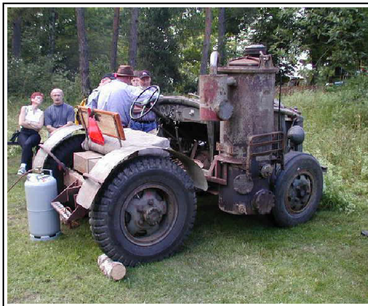
Figura 2.13 Tractor de Gasógeno (EXPOBIOENERGÍA, 2006)
