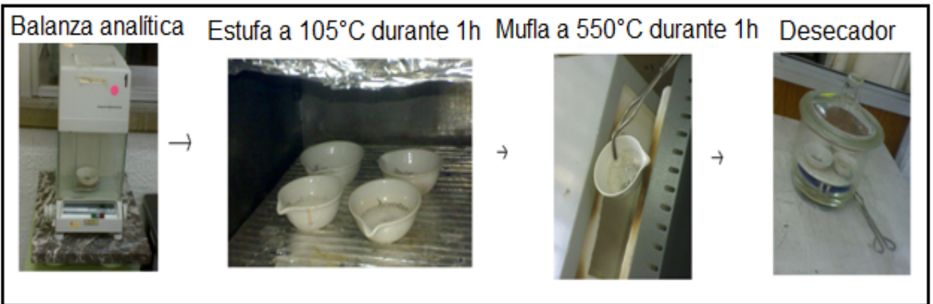
Figura 3.4 Determinación de sólidos totales, fijos y volátiles
