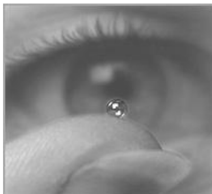
Fig. 7.21 Cápsula de combustible preparada para el reactor de fusión de confinamiento inercial NIF, rellena de Deuterio y Tritio.
