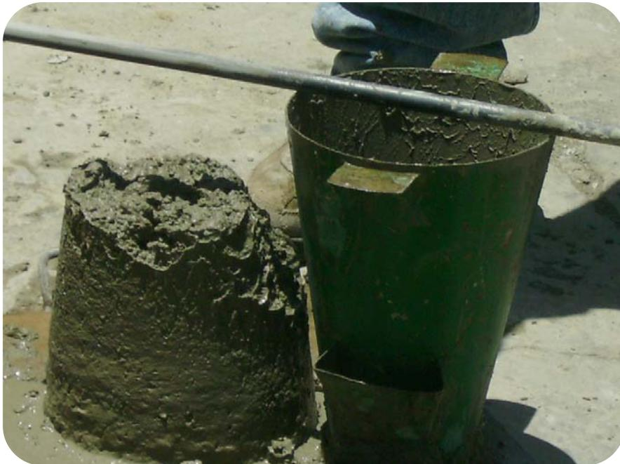
**Figura 2.6 Prueba de revenimiento.**
