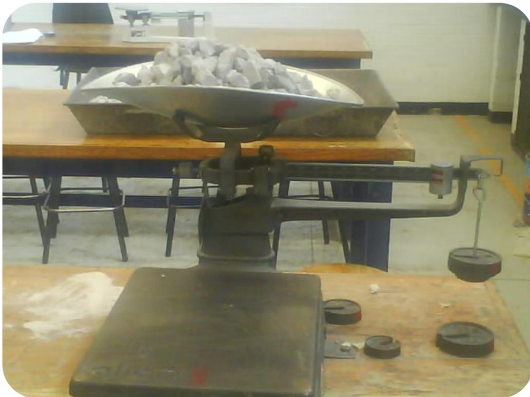
**Figura 2.1** Pesado de los agregados.
