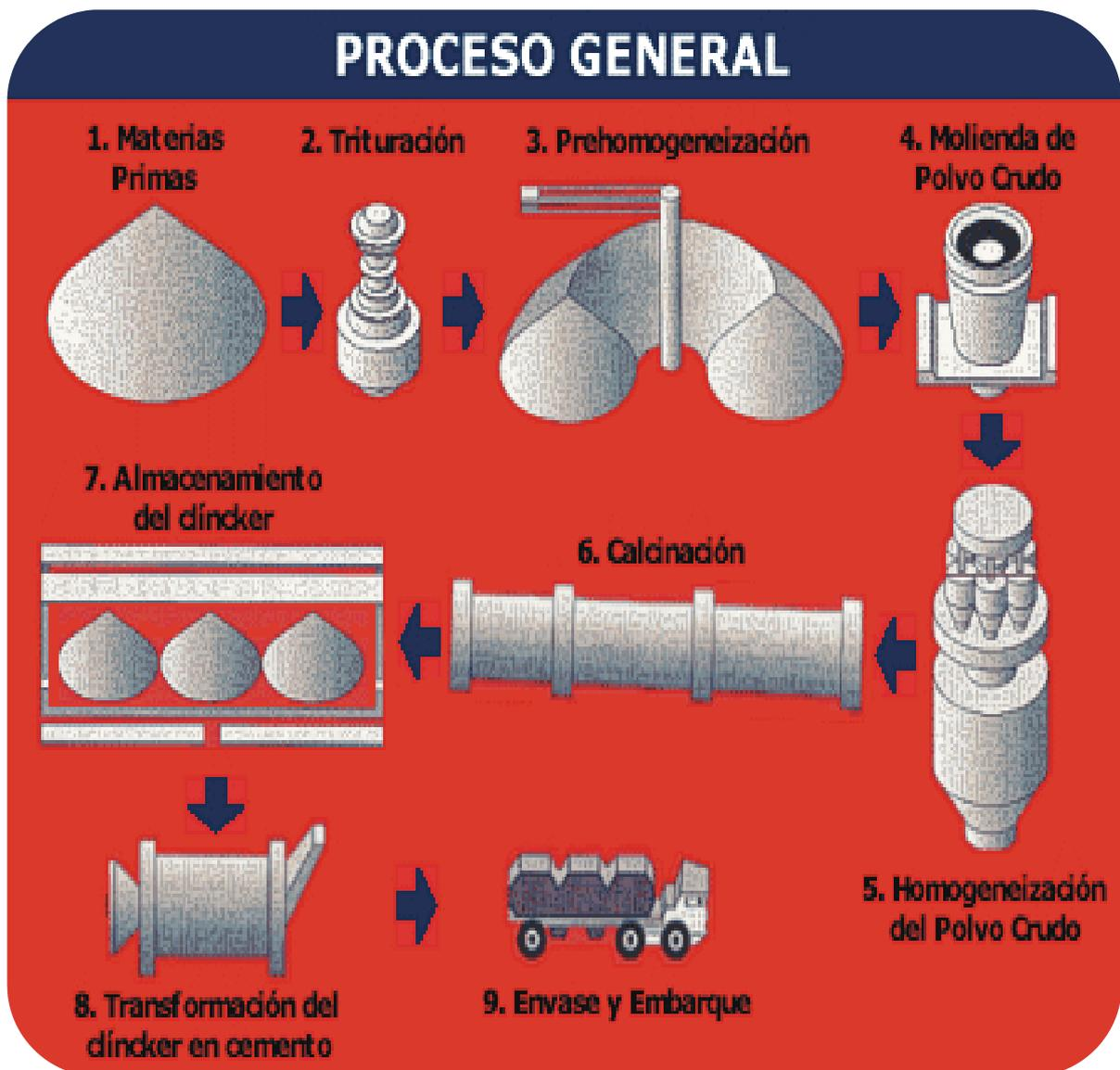
Figura 1.4 Proceso de fabricación del Cemento Portland. (CRUZ AZUL, 2009).
