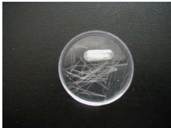
Figura 4.1. Fibra óptica cortada y encapsulada, lista para ser irradiada.
