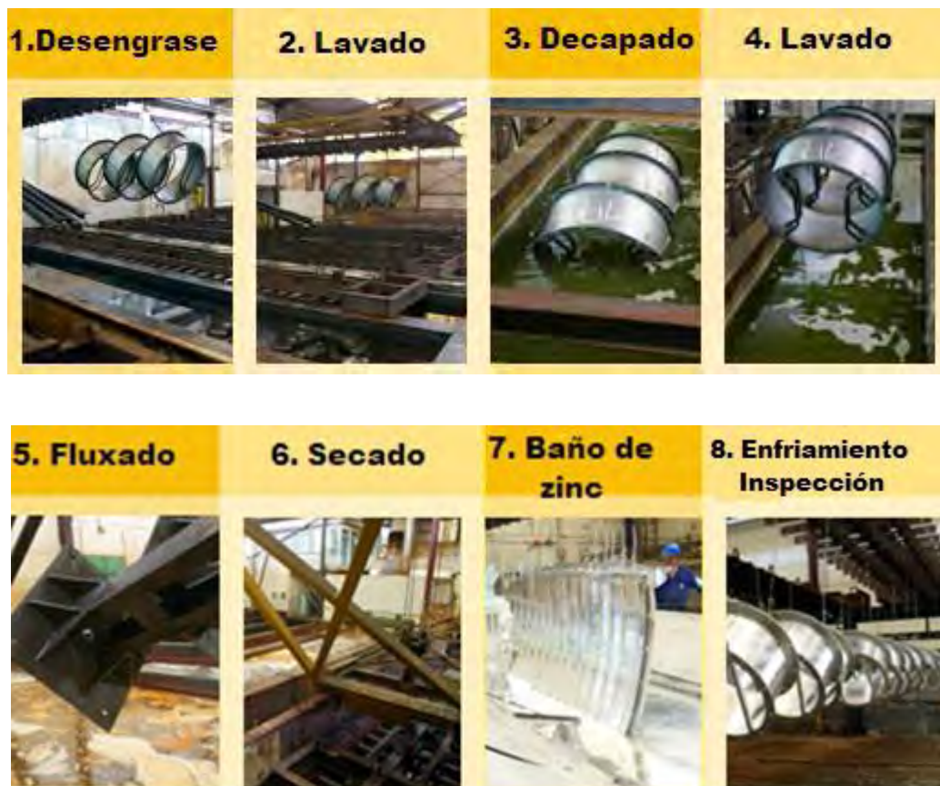
Figura 2.3. Proceso de galvanizado
