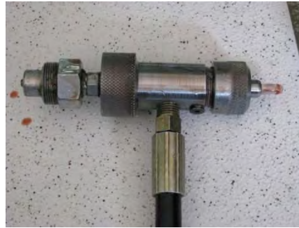
Figura 55, Dispositivo Ensamblado del Banco de Pruebas “Blow Out”.
