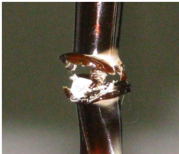
Figura 32, Falla Típica de Tensión que se Presentó en la Unión de las Boquillas. Muestras Ensayadas a Temperatura Ambiente.
