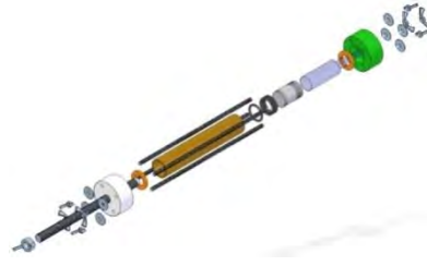
Figura 47, Explosivo del Segundo Prototipo Elaborado para Desarrollar el Banco de Pruebas “Blow Out”.
