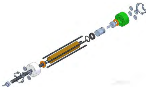
Figura 50, Explosivo del Tercer Prototipo del Banco de Pruebas "Blow Out".
