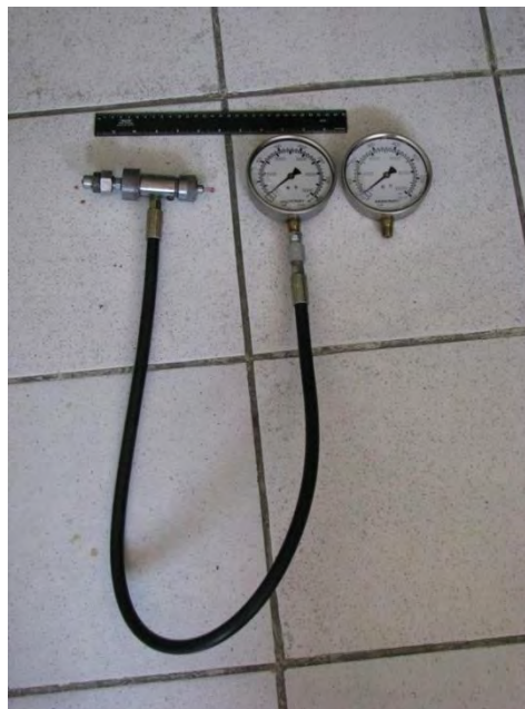
Figura 54, Detalle del Banco de Pruebas “Blow Out” que Muestra el Instrumento para la Medición (Manómetro) de la Carga Hidrostática
