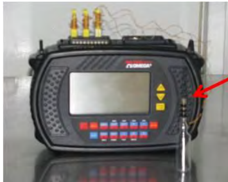
Figura 22, Arreglo Ampollita-Termopar Diseñado para Medir con Precisión la Temperatura en la Boquilla de la Ampollita
