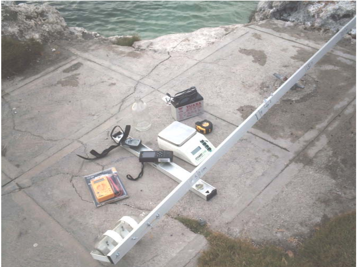
Fotografía 2. Material usado en la toma de muestras, para determinar las densidades del agua (Manantial, Lago-cráter), 9 de Noviembre del 2008.
