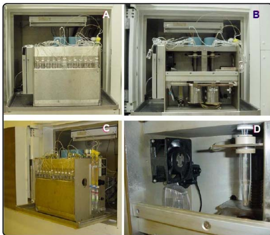
Ilustración 10 Composición de fotografías del CPCU. A) Vista frontal con la cubierta donde se colocan los reactivos. B) Vista frontal sin cubierta se observan los baños de aceite. C) Vista lateral donde se puede colocar columnas de purificación. D) Vaso de reacción montado en el elevador.
