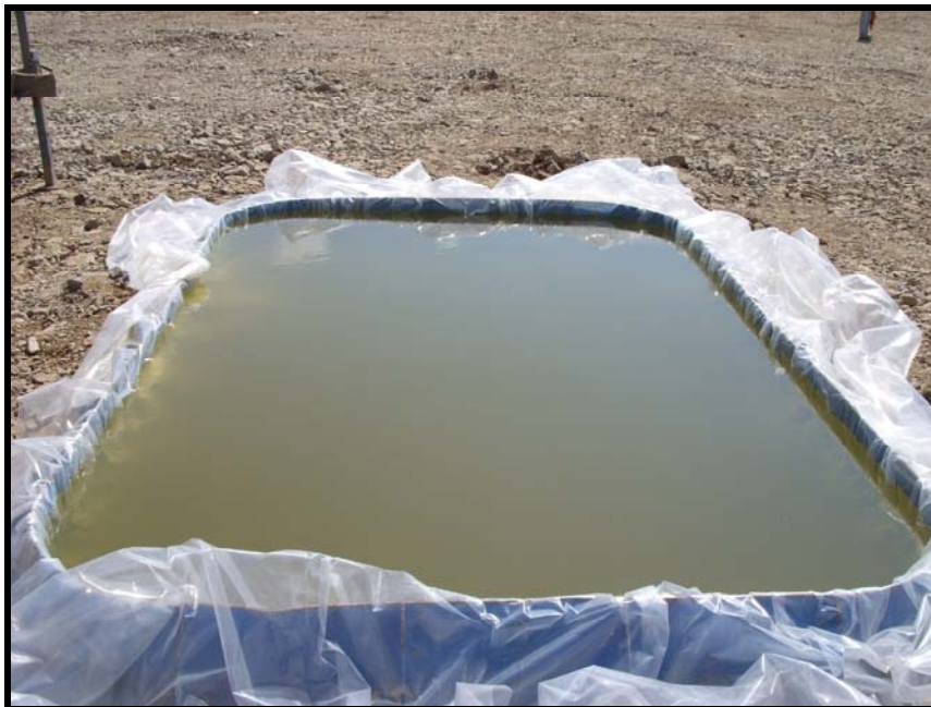
Fig. no. 35.- Una vez lleno el pozo se toman las lecturas de las buretas.
