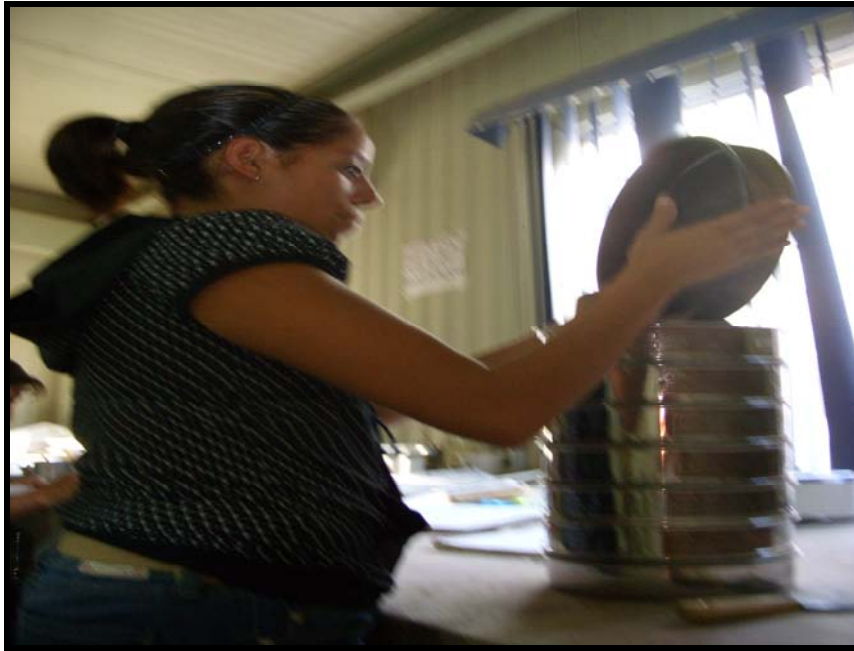
Fig. no. 18.- Realización de la prueba de granulometría.
