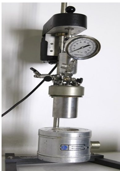
Figura 4.3. Reactor por lotes donde se llevó a cabo la reacción de HDS.
