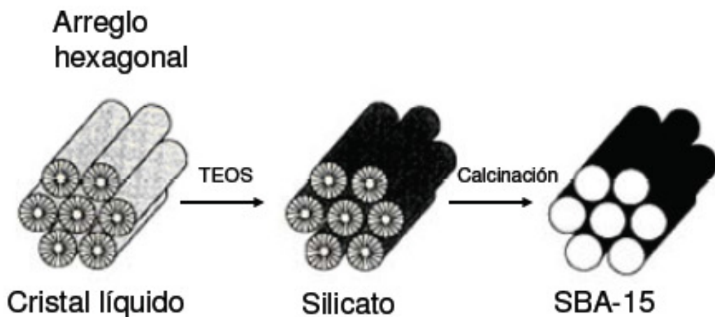
Figura 2.4. Mecanismo de formación de SBA-15 [19].
