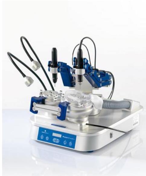
Figura 3-4 Fresador Ceramill de pantógrafo vertical.
