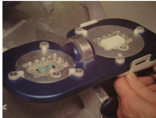
Figura 3-1 Posicionamiento del modelo guía y el bloque de zirconia presinterizada sobre las platinas.
