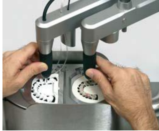
Figura 3-7 Tallado de la estructura de zirconia siguiendo la guía de resina en el fresado de Zirkonzahn.
