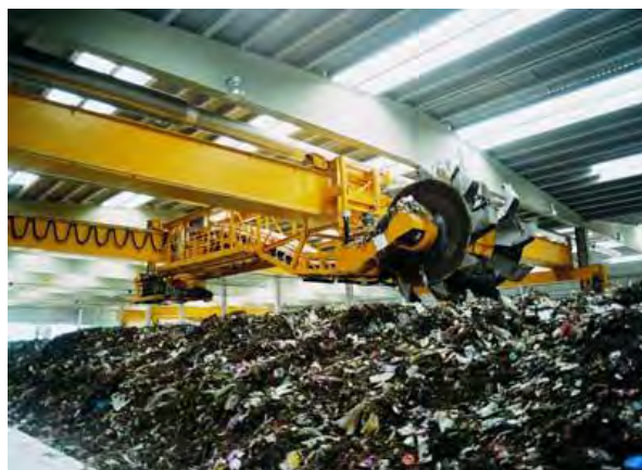
Figura 7. Maquinaria para el tratamiento Mecánico – Biológico, Taim Weser en la exposición Exporecicla 2008 en Zaragoza México
