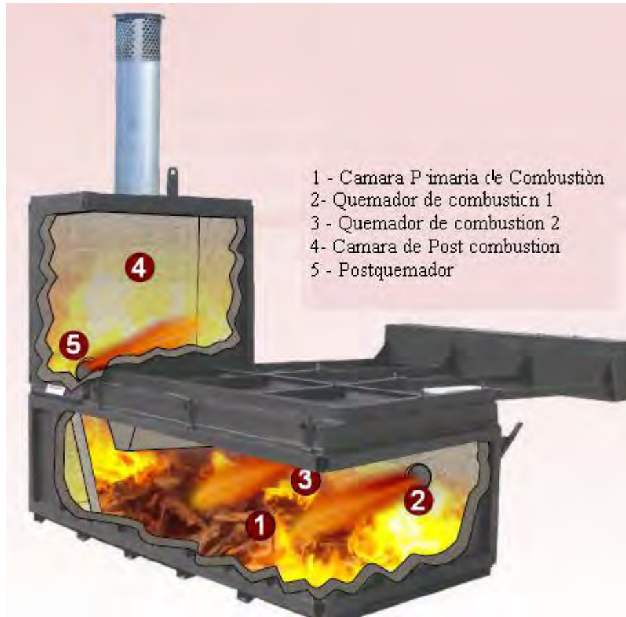
Figura 13. Diagrama del incinerador A2600 (HF)
