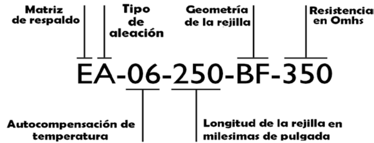
Figura 3.7 Descripción de cada uno de los parámetros en el extensómetro eléctrico (Measurements Group Inc., 2000).
