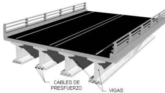
Fig.1.17 Vigas de concreto pres forzado.
