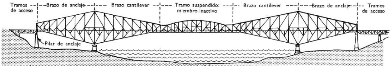
Fig.1.21 Puente en cantiliver.
