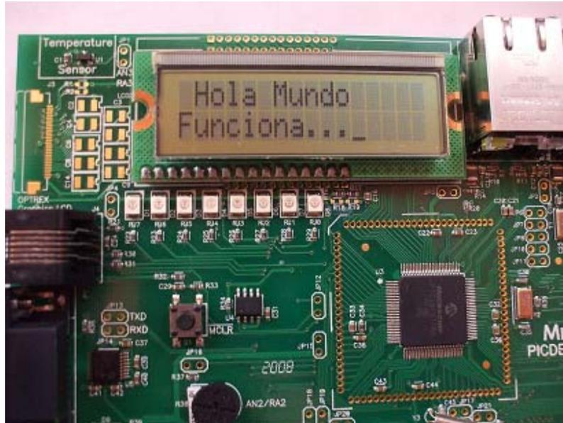
Figura 3.12 Segunda prueba con la tarjeta – Control LCD
