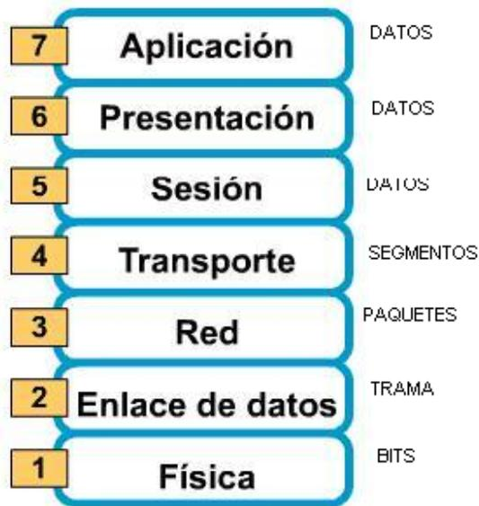
Figura 2.9 Capas modelo OSI
