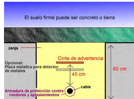
Figura 5.3.c.2. Acceso al edificio (enterrado directo).
