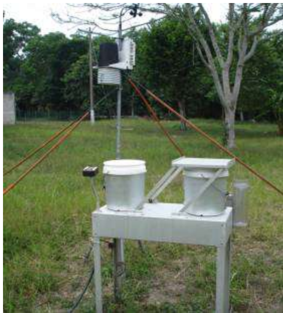
Figura 3.5.- Colector de depósito húmedo y seco, estación meteorológica y pluviómetro ubicados en El Tajín Aerochem Metrics Modelo 301
