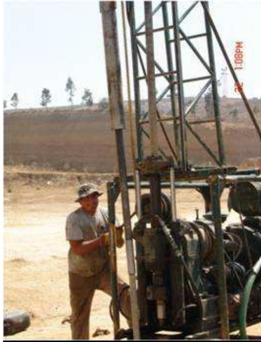
MOMENTO EN QUE SE HINCA EL TUBO PARTIDO PARA MEDIR LA RESISTENCIA DE LOS MATERIALES Y OBTENER UNA MUESTRA REPRESENTATIVA
