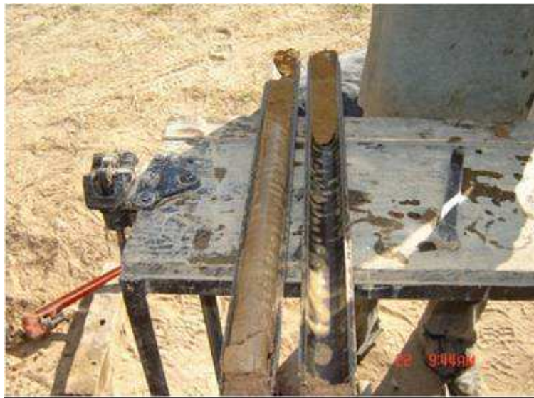
MUESTRA DEL MATERIAL DEL SUBSUELO, OBTENIDA EN EL SONDEO SPT - 1
