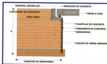
SECCIÓN TÍPICA DEL MURO DE CONTENCIÓN MECANICAMENTE ESTABILIZADO
