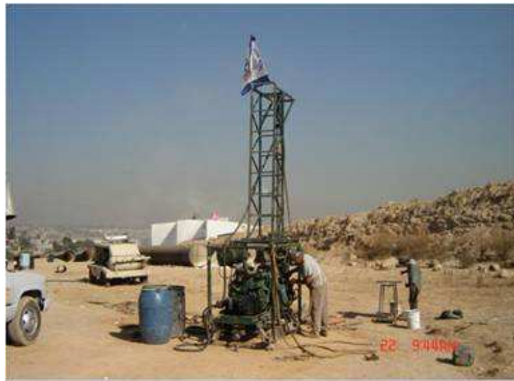
VISTA FRONTAL DE LA MAQUINA LONG-YEAR, EN EL SONDEO DE PENETRACION ESTANDAR DENOMINADO SPT - 1
