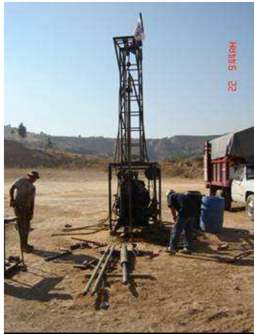
VISTA FRONTAL DE LA MAQUINA LONG-YEAR, EN EL SONDEO DE PENETRACION ESTANDAR DENOMINADO SPT - 1
