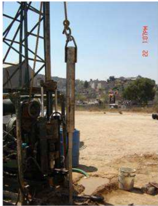
MARTILLO EMPLEADO PARA HINCAR EL MUESTREADOR DE PARED GRUESA O TUBO PARTIDO
