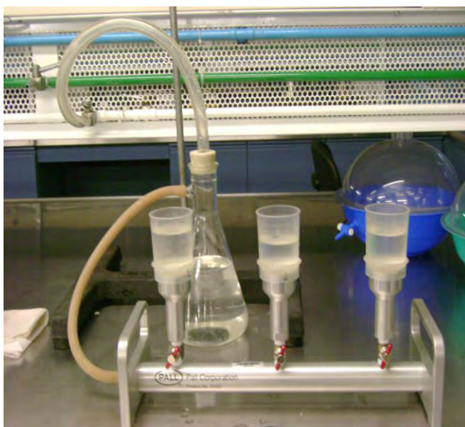
Fotografía 2.5 Sistema experimental utilizado para simular un filtro de arena.
