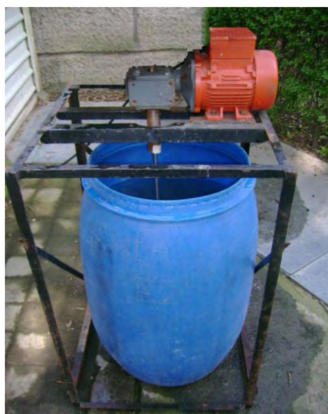
Fotografía 2. 4 Equipo de coagulación-floculación.
