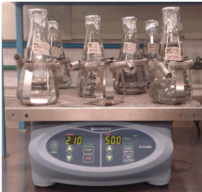
Fotografía 2. 6 Dispositivo experimental utilizado en las cinéticas de adsorción.
