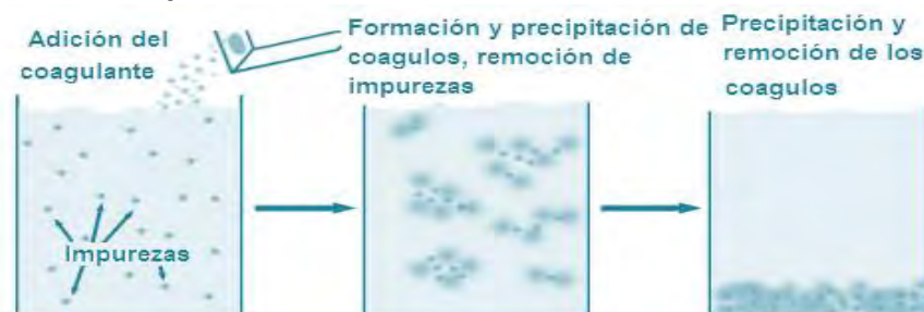
Figura 27. Esquema de la remoción de contaminantes mediante la dosificación de agentes coagulantes.
