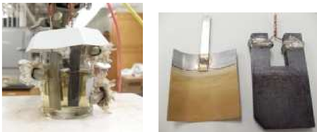
Figura 20. Celda de electrólisis (izquierda) y electrodos después de la reacción (derecha)
