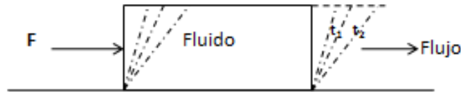
Figura 1.2 Deformación continua de un fluido bajo la acción de un esfuerzo.
