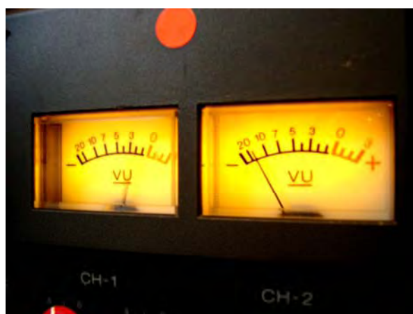
Unidad de medición de volumen, indica la intensidad relativa de un sonido (VU). Foto: Ivette Michel
