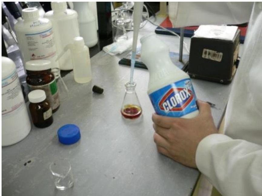
4. Adición de la solución de hipoclorito de sodio y oxidación para la producción de yodo
