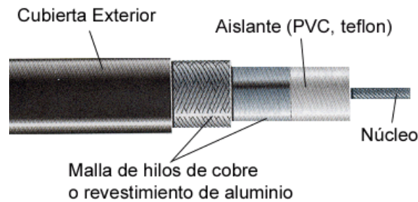
Fig. 2.1 Estructura de un cable coaxial
