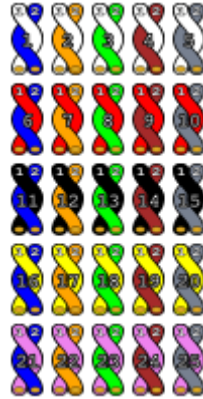
Fig. 2.7 Código de colores del par trenzado
