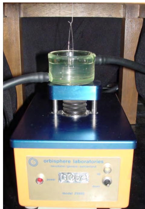
Figura 5.8. Equipo para medir tensión superficial por el método del anillo
