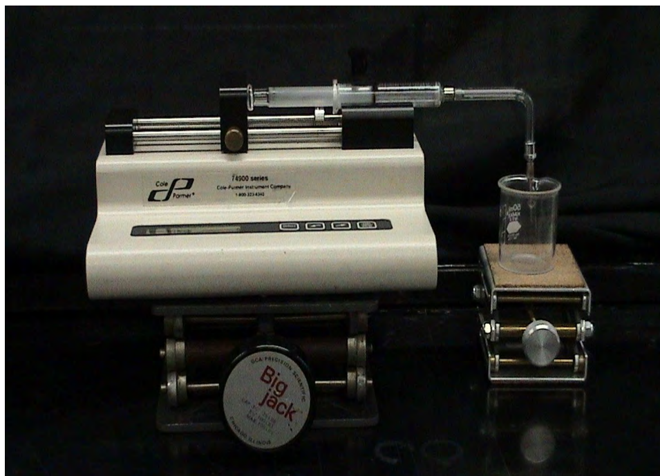
Figura 5.1. Equipo para medir tensión superficial e interfacial por el método de pesada y/o volumen de gota
