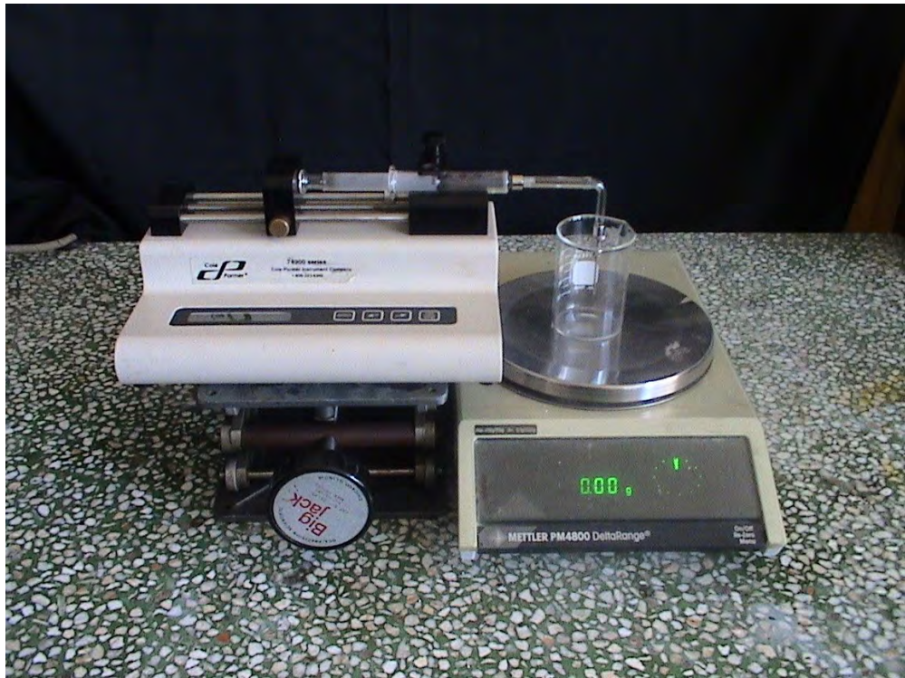
Figura 5.4. Equipo para medir tensión superficial e interfacial por el método de pesada y volumen de gota
