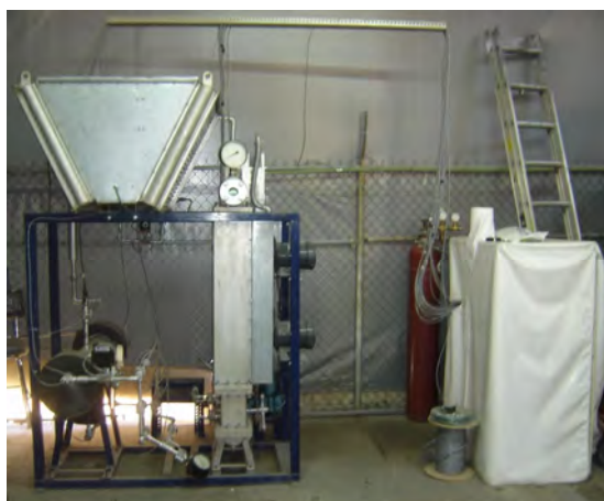
Fig. 3.3.2.4 Sistema de refrigeración, con instrumentos de medición.
