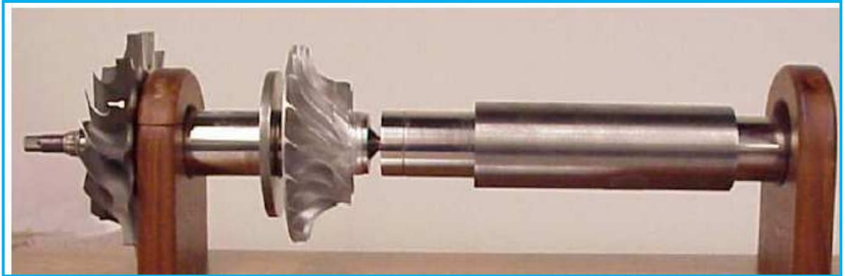
Figura 12. Eje de la Micro Turbina
