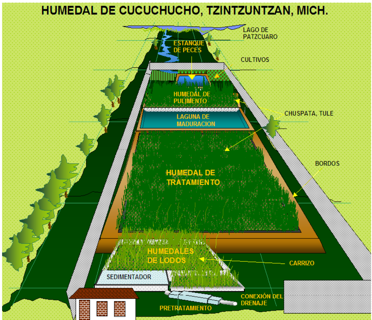
Figura 3.2 Tren de tratamiento con humedales artificiales como tratamiento secundario, instalado en Cucuchucho, Mpio. de Tzintzuntzan, Michoacán. Tomado de Urquiza et al. (2005).
