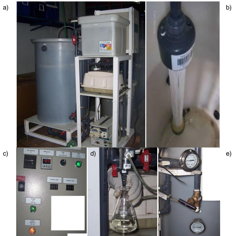
Figura 3.2 Fotografías del sistema experimental. (a) Vista general; (b) módulo de membranas de ultrafiltración; (c) panel de control; (d) efluente del BRM; (e) vacuómetro y termómetro
