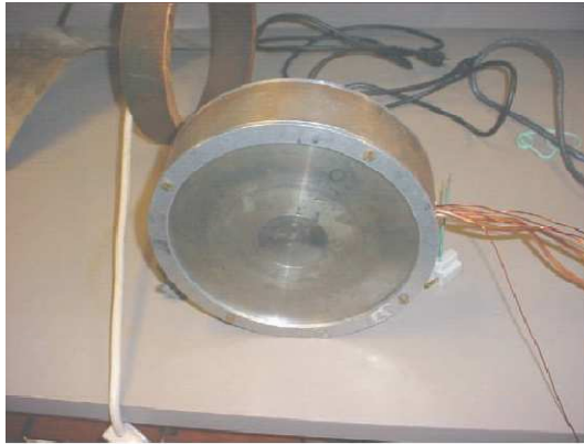
Figura 4.11 Fotografía de un polarímetro Compton.
