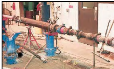
Figura 2.39 Válvula para sarta de perforación (DSV) siendo probada.
