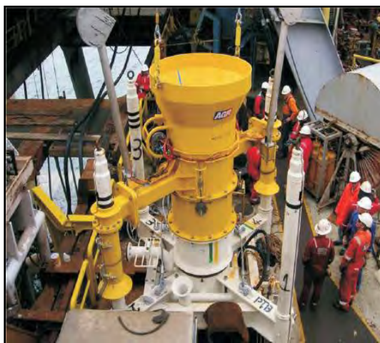
Figura 2.31 Módulo de Succión del sistema RMR siendo preparado para su introducción al mar.
