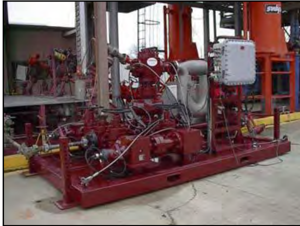
Figura 2.8 Sistema de estrangulamiento automático para operaciones en tierra.
