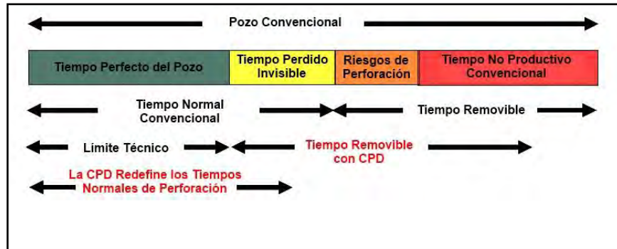
Figura 1.1 División de eventos durante la perforación de un pozo. En la figura se puede observar que con el uso de una técnica correcta de CPD puede mitigarse en cierta medida el Tiempo No Productivo debido a los riesgos de perforación, al ILT y al NPT convencional.
