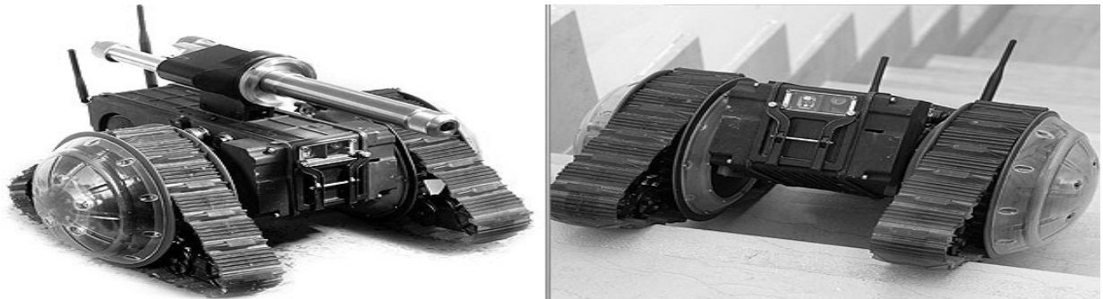
Fig.4.11 El VIPeR puede subir escaleras (derecha) y abrir fuego contra objetivos con una subametralladora. A la izquierda, esta máquina de 23 cm de altura está equipada con una pistola de agua capaz de desactivar bombas.
