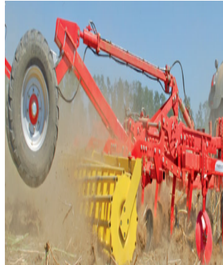
(b) El mecanismo permite bajar la rueda de transporte
