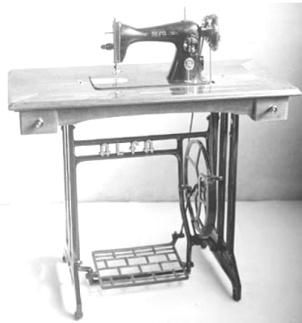
(e) La barra 3 es un balancín para mover un volante que acciona a la cosedora.
