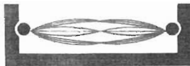
Figura 1-54. Vista estroboscópica de una sola cuerda que vibra simultáneamente en sus modos fundamental y de segundo armónico.
