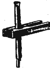
Figura 2-1. Aparato de Tyndall para ilustrar la producción de calor por frotamiento.
