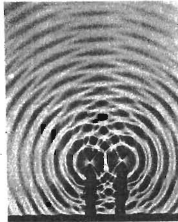
Figura 1-47. Patrón de interferencia de las ondas de agua de dos fuentes puntuales. Localice las líneas nodales y antinodales.
