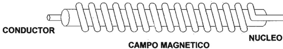
**Figura 1.17 - Campo magnético generado por una bobina con un núcleo**
