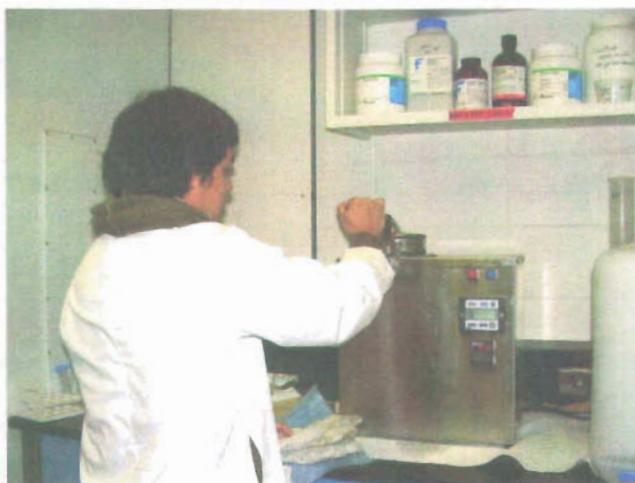
Figura 1. Aparato de digestión ANKOM Technology – 8 / 98 para análisis de fibra.
