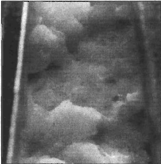
^Eliminación de incrustaciones de carbonato de calcio con chorros de agua. La tubería de producción recibió un solo chorro de agua a razón de 2,4 pulg./min [1 mm/seg]. Si bien se ha logrado remover los sedimentos de carbonatos, todavía se observa una cantidad remanente considerable.
