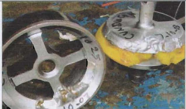
En la foto se muestra como se deslava la válvula con la presión al ser calzada con sólidos,
