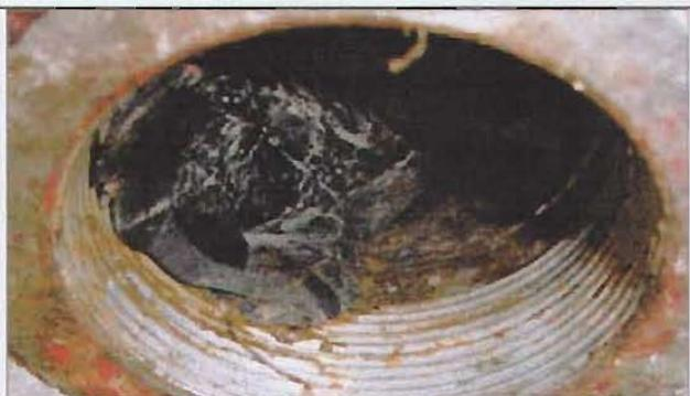
Por increíble que parezca este material que se observa de este lado de la válvula de seguridad lo traspaso y con la inmensa presión que maneja la bomba hizo que llegara hasta la parte de adentro de la bomba.
