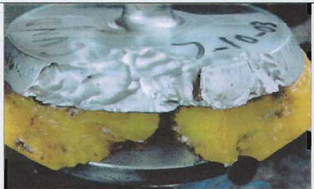
**AFLOJAMIENTO DE TAPONES POR ACTIVIDAD DE TRABAJO, OCASIONANDO FISURAS. (CORTES POR PRESION)**
