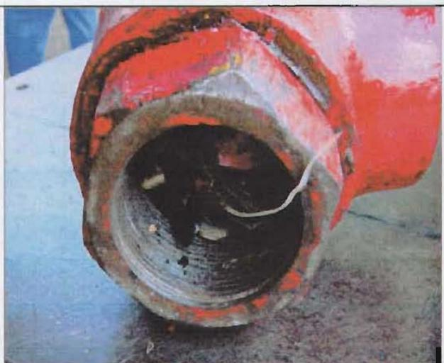
Observe como en el interior de la válvula de seguridad se encuentran pedazos de hule y material que no tiene que ver con el lodo que maneja.
