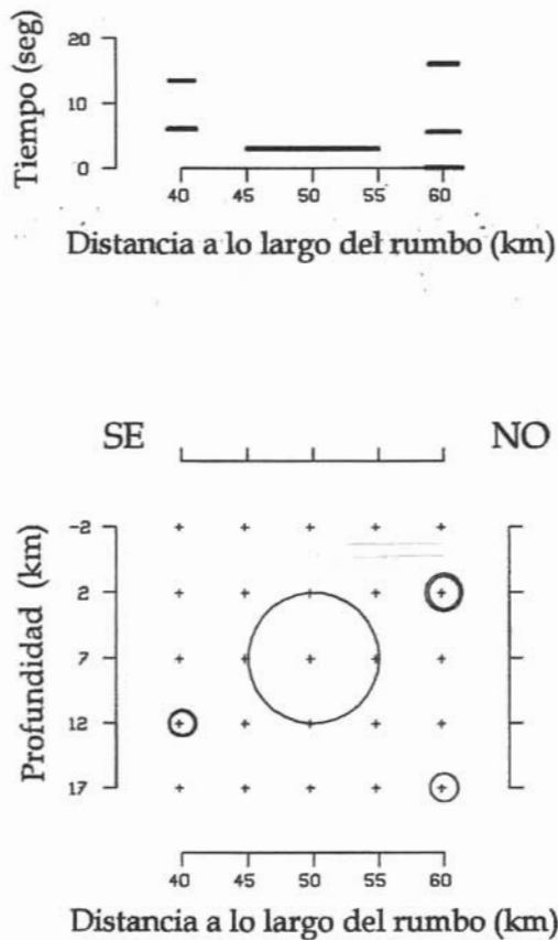
Fig. IV.24 La fuente principal localizada por el programa de inversión se encuentra a una profundidad de 7 \pm 2 km. Pequeñas fuentes cercanas a la principal favorecen al ajuste del sintético con el observado.
