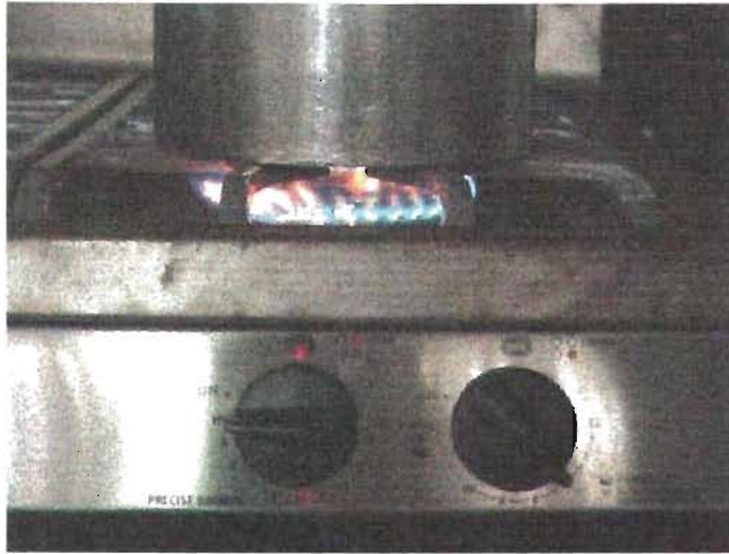
Fotografía 4.7.2 Muestra la flama amarilla que producen los depósitos de carbón.
