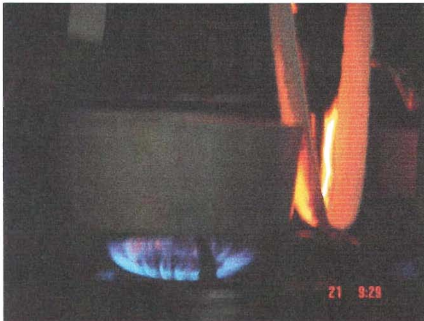
Fotografía 4.5.4.3. Muestra el momento en el que la prueba falla al presentarse flama en la tela.
