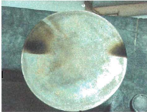
Fotografía 4.5.5.2. Muestra el depósito de carbón resultado de las flamas amarillas resultado de la inadecuada combustión.
