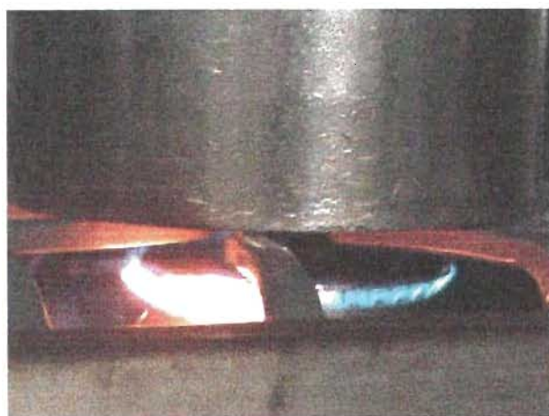
Fotografía 4.5.5.1. Muestran la flama amarilla con gas LP.
