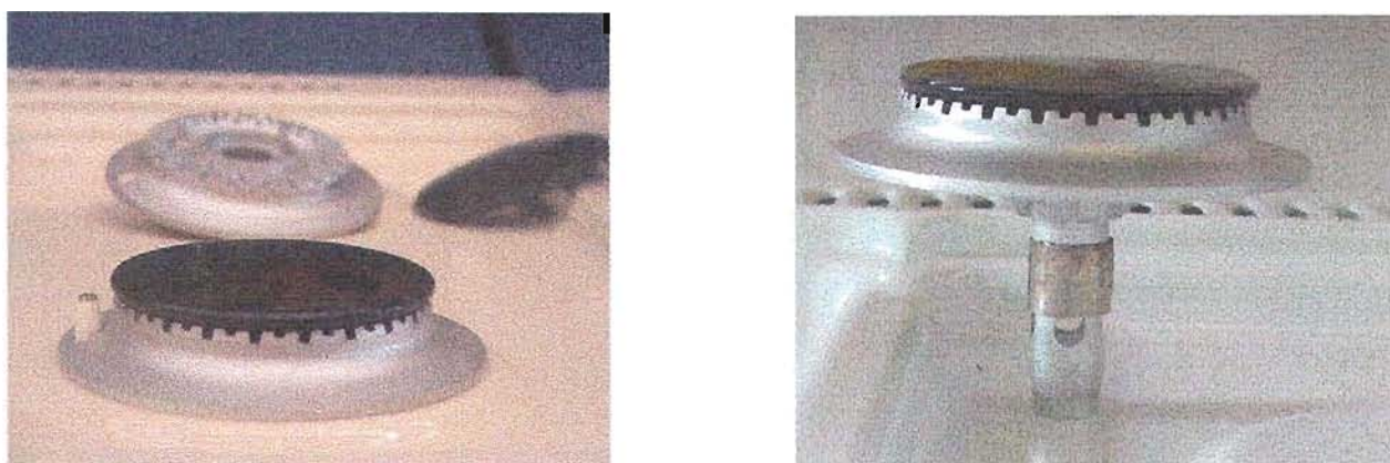
Fig. 1.6.3 Quemador atmosférico utilizado en México, con inyección vertical del gas en una cubierta sellada con ajuste de aire primario a través del anillo.
