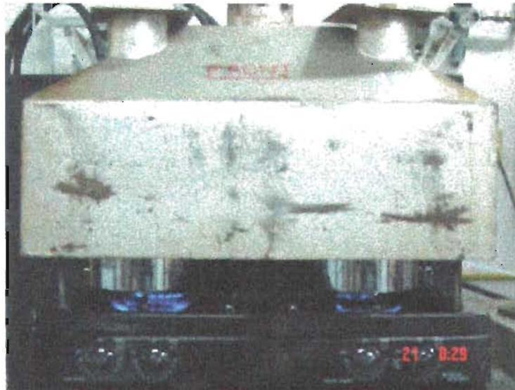
Fotografía 4.5.3. 1 La foto muestra la forma de coleccionar los gases de combustión generados por los quemadores a través de una campana.
