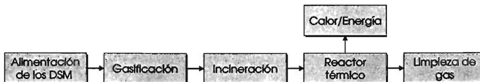
Figura 2.11. Diagrama de bloques del proceso desarrollado por Energos Technology
