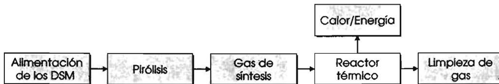
Figura 2.16. Diagrama de bloques del proceso desarrollado por ENTECH Renewable Energy System
